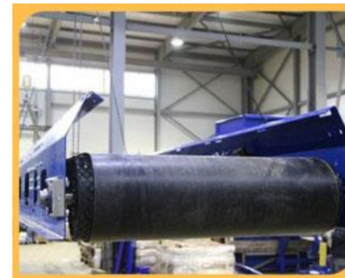
2. Транспортеры ленточные для подачи ТБО в сепараторы роторного типа
