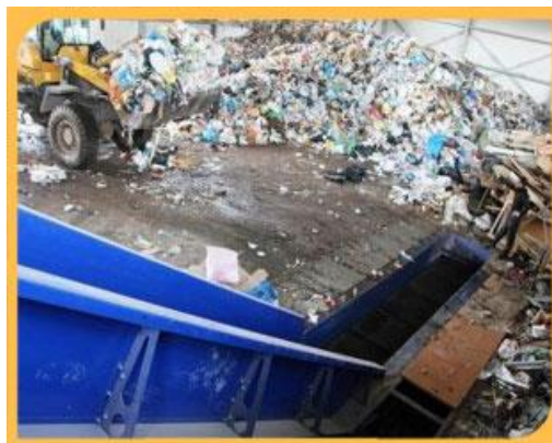
1. Конвейеры подающие цепные для подачи материала на сортировочные конвейеры
