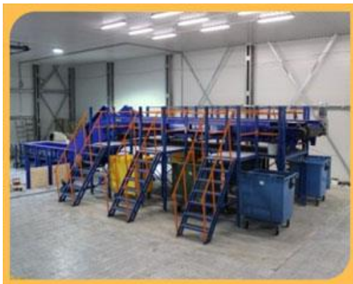
7. Конвейер реверсивный для подачи несортируемого ТБО в мусороперегрузочные прессы
