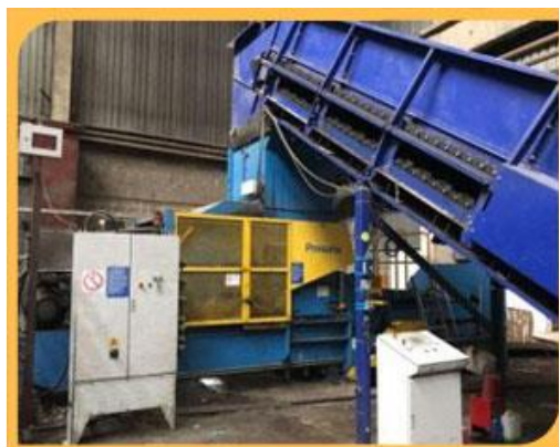
9. Конвейер цепной, подающий полезные фракции в автоматический пресс
