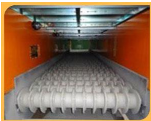
3. Сепараторы роторного типа (10 валов) для отсева мелкой фракции ТБО (80 мм)
