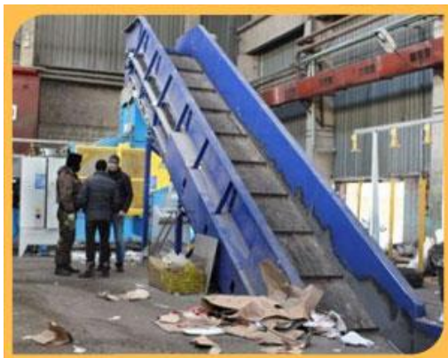
9. Конвейер цепной, подающий полезные фракции в автоматический пресс
