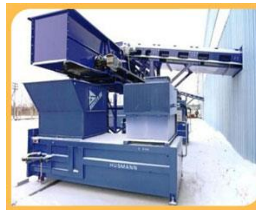
8. Мусороперегрузочные прессы МР 1300 для прессования несортируемых отходов (коэффициент 1:4)
