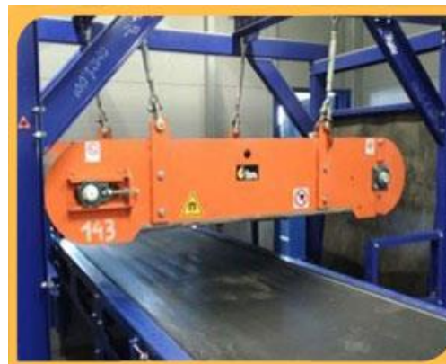
4. Магнитные сепараторы для извлечения металлического мусора из ТБО
