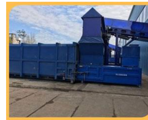
8. Мусороперегрузочные прессы МР 1300 для прессования несортируемых отходов (коэффициент 1:4)
