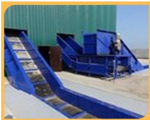
1. Конвейеры подающие цепные для подачи материала на сортировочные конвейеры
