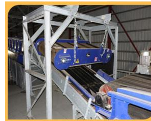
4. Магнитные сепараторы для извлечения металлического мусора из ТБО
