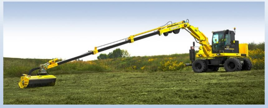
Манипулятор из конструкционной стали Weldox: разделен на 3 части, с 3-мя телескопическими штангами, с максимальной **общей длиной 17 метров** (от центра машины до режущей головки).
